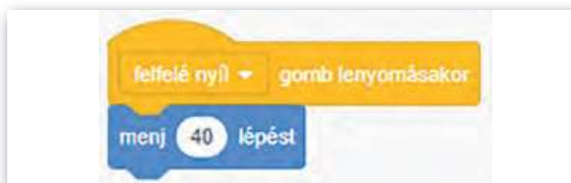
► A felfelé nyíl hatására előrelép a szereplő 40 egységet (Scratch környezet)
